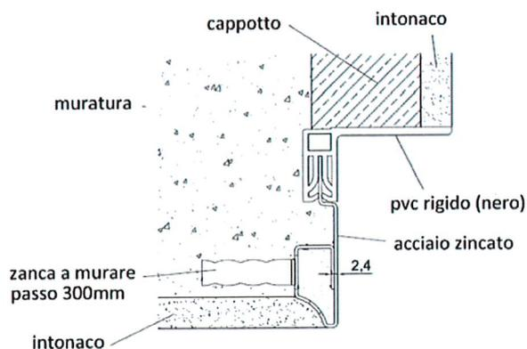
*Controtelaio in tubo d'acciaio*
