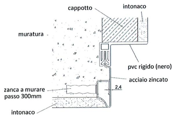
*Controtelaio in tubo d'acciaio*
